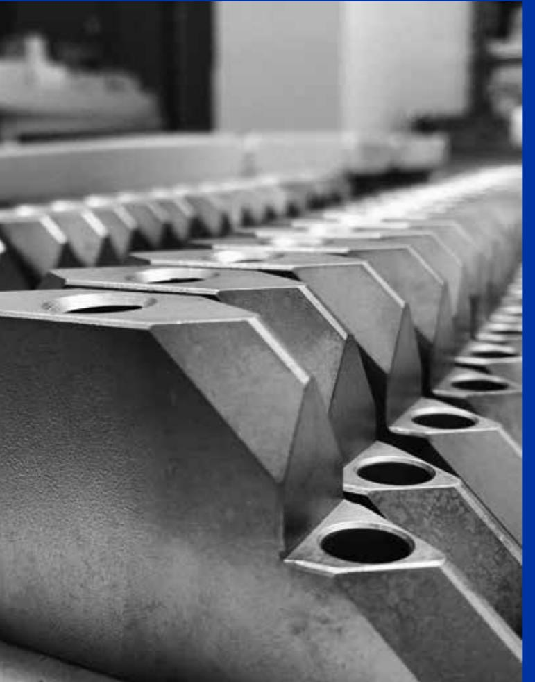
Keilmechanik sorgt für Spannung.
